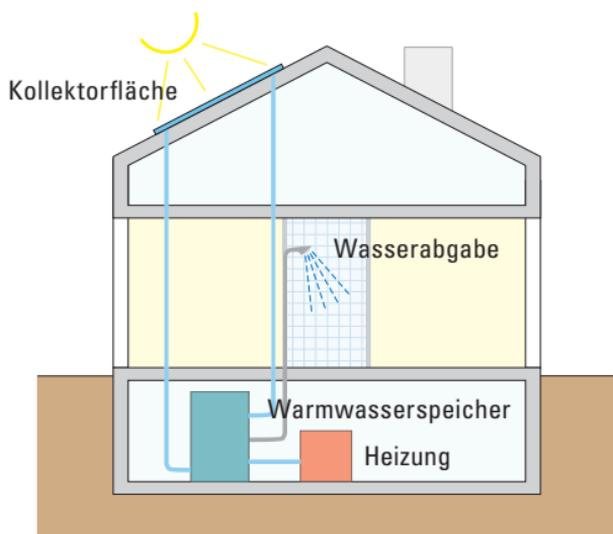
Ein nachträglicher Einbau einer Solaranlage zur Wassererwärmung ist grundsätzlich immer möglich und lässt sich mit jedem anderen Heizsystem und Energieträger kombinieren. Der Warmwasserspeicher wird so bemessen, dass genügend Warmwasser für 2-3 Tage zur Verfügung steht. So ist immer ein Vorrat vorhanden, wenn einmal die Sonne nicht scheint.
